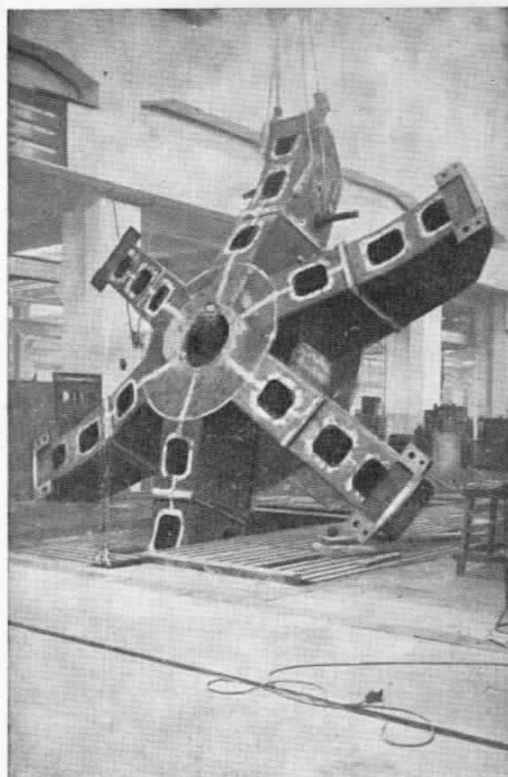
Kuva 14. Kotimaassa valmistettu generaattori-ristikko.
