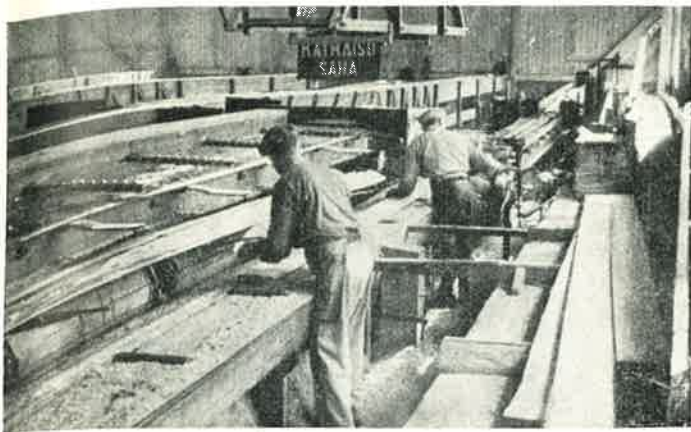
Sivulaudat putoavat kuljettimille, jotka takaavat, että särmääjällä riittää työtä.
