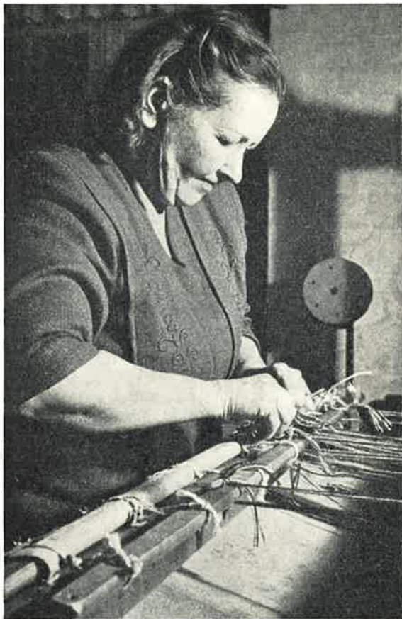
Kankaan rakentaminen on päättymässä. Näppärästi rva. M a n k k i solmii loimilangat aloitusvarpaan.
