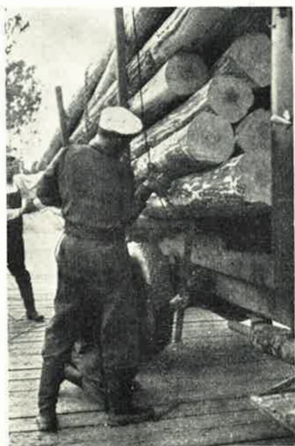
Autokuorma sidotaan nipuksi.
