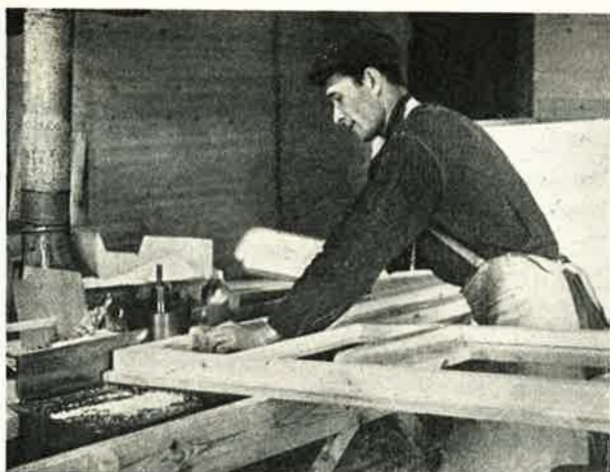
Frans Solonen suorittamassa ikkunapuitteen ympäriajon, jossa tarkka mitta määräytyy.
