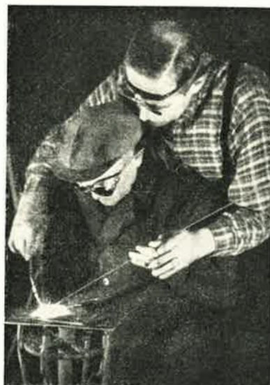
Hitsausteknikko K. Gustafsson opettaa konepajamme työnjohtajalle Lauri Lundbergille "kädestä pi-täen" kaasuhitsauksen salaisuuksia, n.s. "käsialan vakavuutta".
