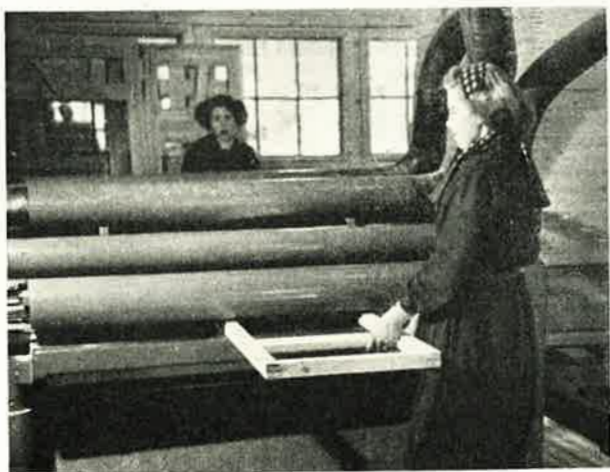
Ikkunapuitteen puhdistus rumpusantaajassa. Taustalla Kaisu Suntio, edessä Inkeri Suntio.
