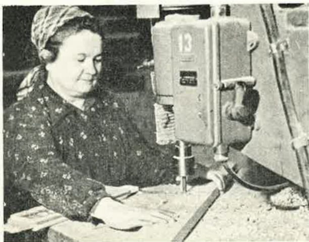
Kuivia, lahoja oksia ei saa olla näkyvissä. Aili Lindholm poraa ne pois ja —
