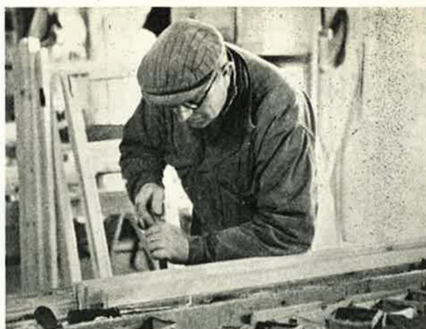
Puite ei ole kuitenkaan valmis ilman heloitusta. Kuvassamme Sulo Virtanen kiinnittämässä saranoita.
