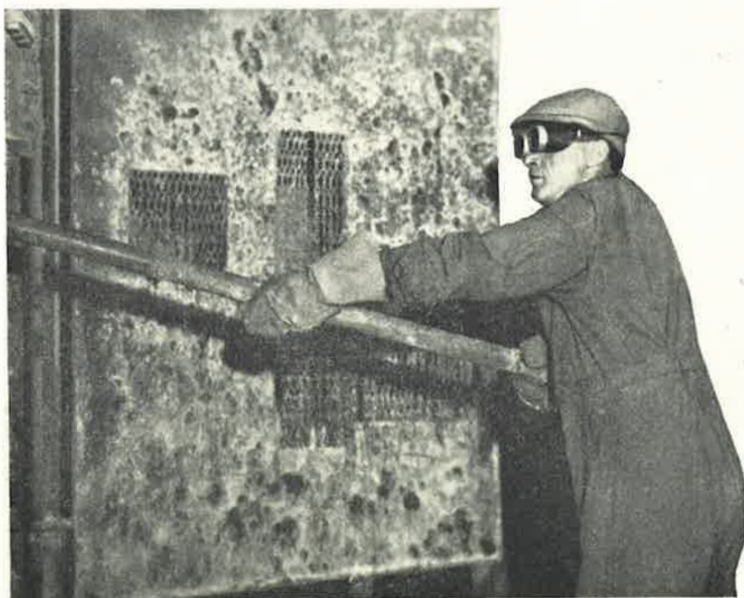
Vieressä: Karbidiuunin reikämies Eino Lindholm pitää karbidiuunin laskuaukkoja valmistellessaan aina mustia suojalaseja silmillään. Kuvassa näkyy karbidin laskun aikana käytettävä suojuspelti kettinkien peittämine aukkoineen.
