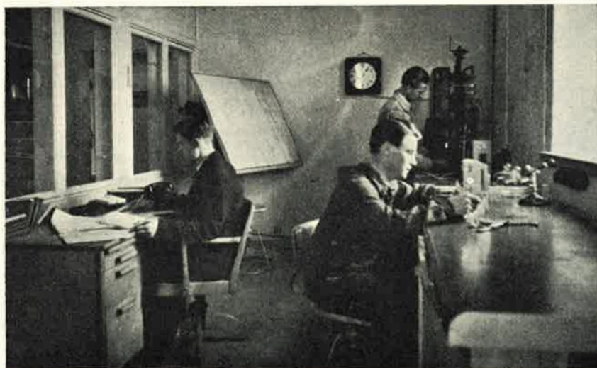
Kattilahuoneen yhteydessä sijaitsee mittarikorjaamo, jossa suoritetaan mittareiden ja säätölaitteiden huolto sekä korjaus.
