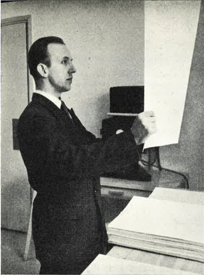
Käyttöinsinööri Erkki Laasonen tarkastaa voimakasta valoa vasten selluloosa-arkkia.
