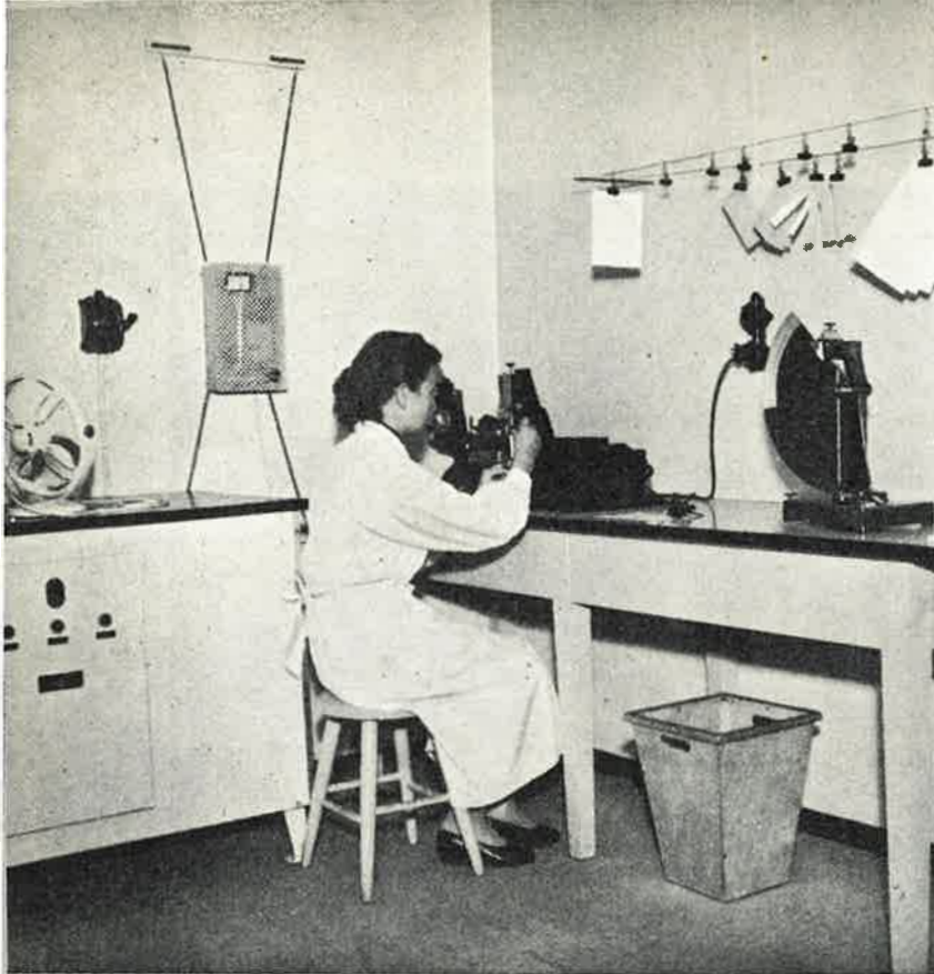
Laborantti Elsa Lyytikäinen suorittamassa ilmastointihuoneessa koearkin taittolujuuskoetta taittolukukokeen avulla.
