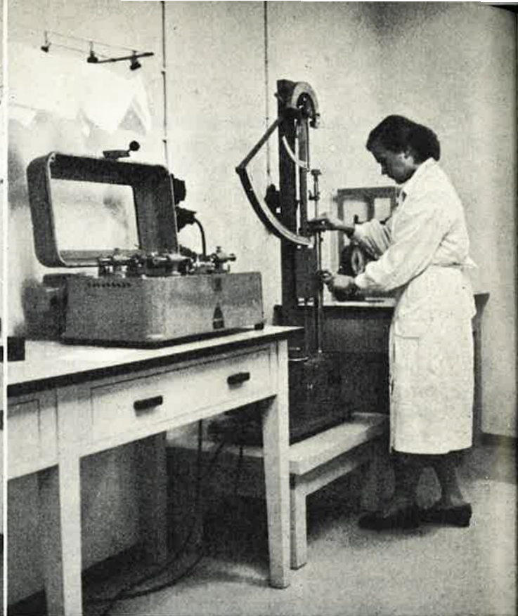
Vetolujuusmääritys suoritetaan tällaisella kojeella. Etualalla toisen tyyppinen taittolukukoke kuin edellisessä kuvassa.
