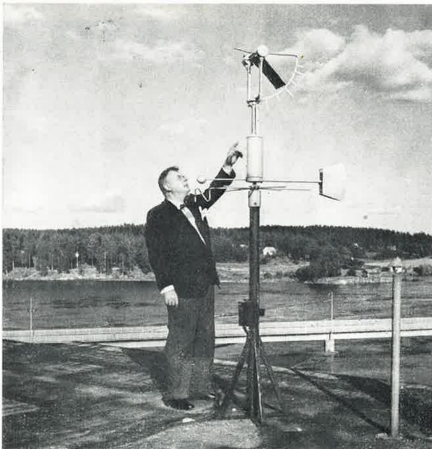
Kymintehtaan kaasusuoje:upäällikkö, dipl.ins. Runar Örnholm selostamassa klooritehtaan katolle sijoitettua herkkää tuulensuunninta, joka automaattisesti ilmoittaa tarkat tiedot hälytyskeskukseen
