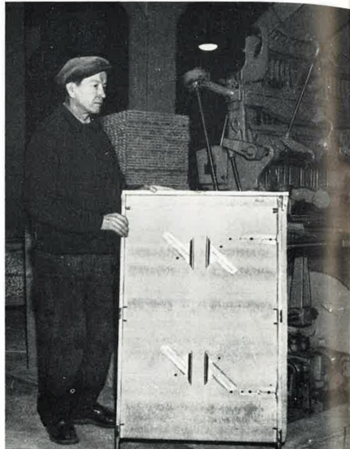
Yrjö Tähtinen ja hänen suunnittelemansa pakkauskehyksen muotti Keskellä olevat irroitettavat lisälaitteet ovat tarpeen ristivannetta käytettäessä
