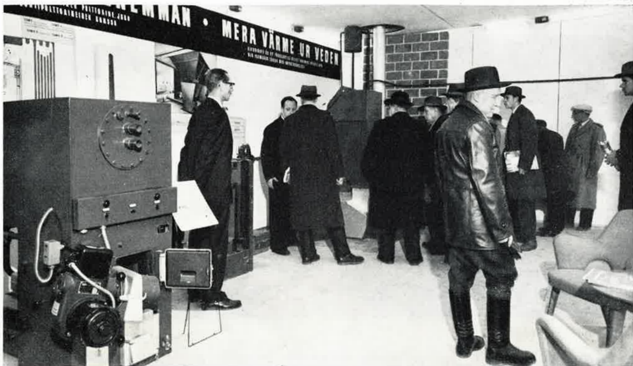
Ylhäällä öljypolttimella varustettu Minor II keskuslämmityskattila ja vieressä lähikuva hakkeepolttimesta
