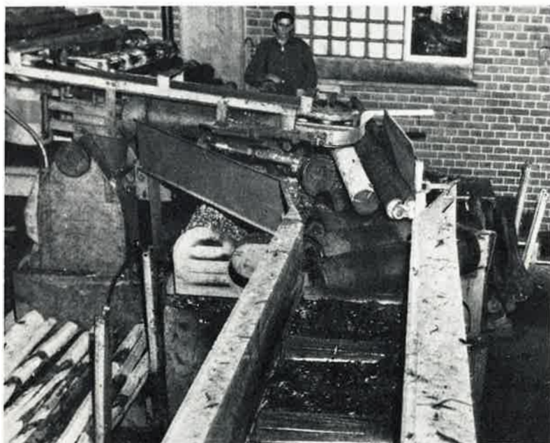
Puiden kuoriminen tapahtuu koneellisesti. Kuorija Vilho Ekholm hoitamassa konettaan
