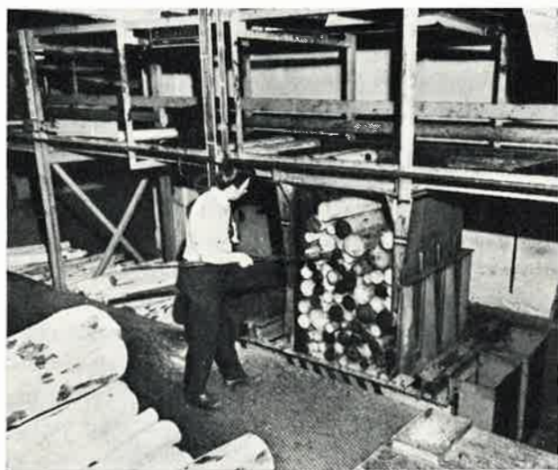
Puut putoavat jakelukuljettimelta hiomakoneen uuniin puiden latojan Martti Kyynäräisen pitäessä huolta, että puut tulevat hyvään järjestykseen
