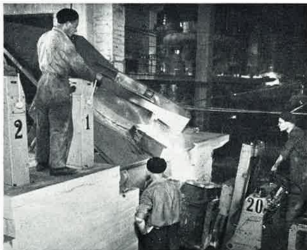
Sulaa rautaa kaadetaan sähkösulatusuunista kuljetusastiaan
