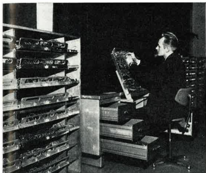
Operatööri Matti Rytkönen suorittamassa tabulaattorikytkentää. Etualalla hyllyissä valmiita kytkentätauluja.
