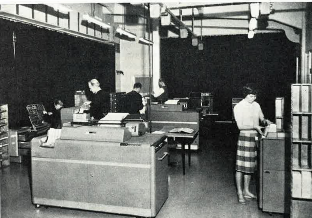
Reikäkorttikeskukseen konesali. Keskellä kaksi tabulaattoria ja niiden takana kalkylaattori.
