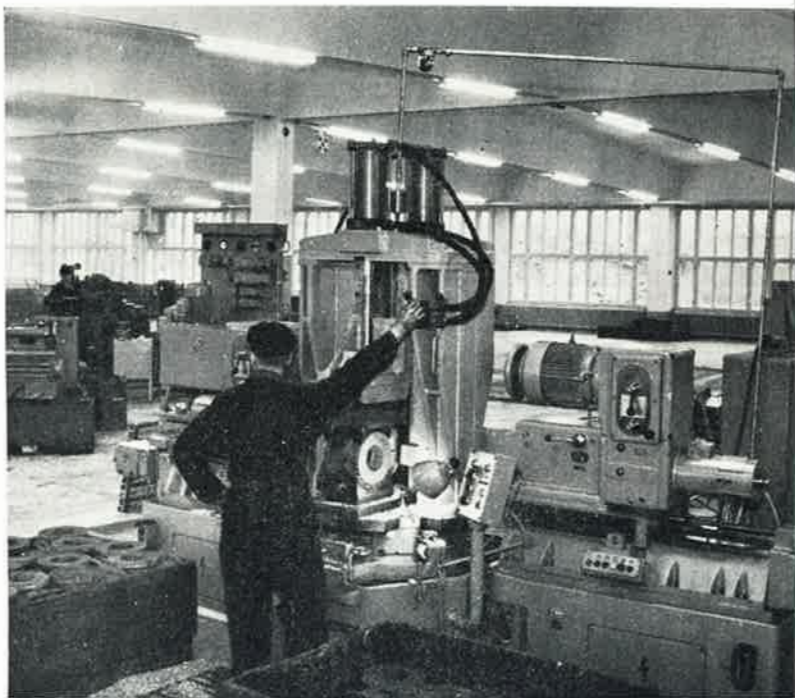
Rva Anja Lehtonen kasaamassa messinkiventtiilejä paineilmalla toimivien 'työkalujen' avulla
