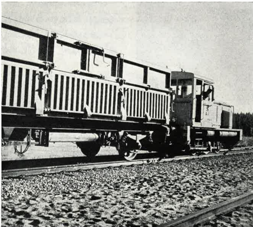
Tällainen uusi erikoisvaunu sopii hyvin kemikaalien ja selluloosapaalien kuljetuksiin
