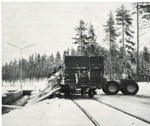
Puskutraktori suistaa koivupuut kuormasta viettävää laskulavaa myöten ränniin
