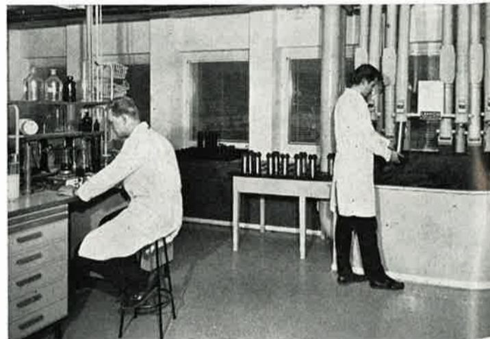
Putkipostin välityksellä saapuu käytöntarkkailu- laboratorioon eri puoliilta tehdasta yhtenäen näytteitä
