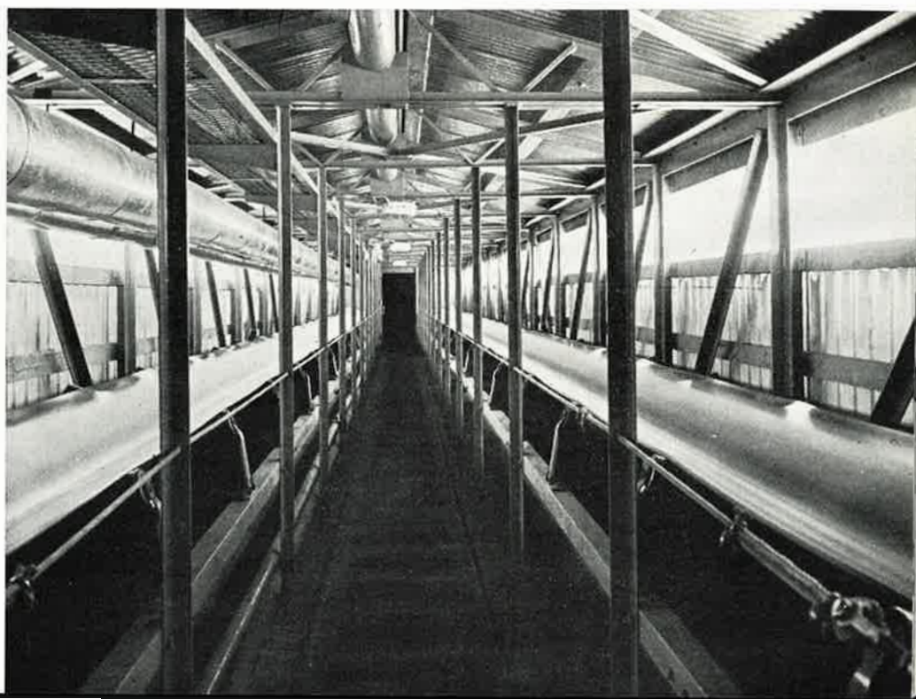
Vasemmalla koivuhake ja oikealla mäntyhake etenemässä kumihihnoin kuljettamana kohti keittämöä
