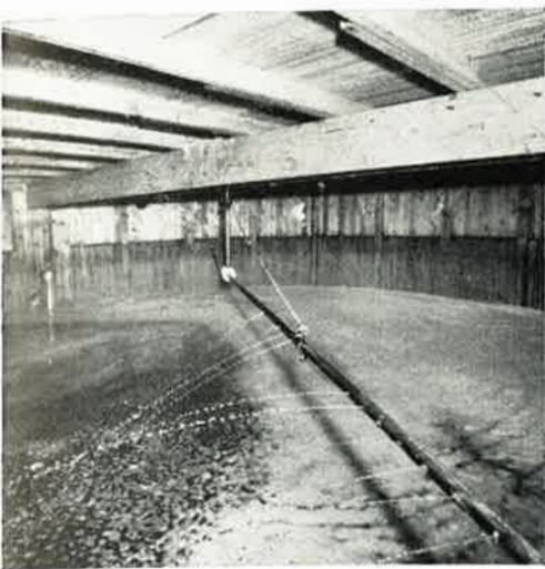
Pääkäyminen tapahtuu katetuissa sammioissa, joissa liikkeessä oleva kuohanpoistolaite estää liemen liian kuohumisen
