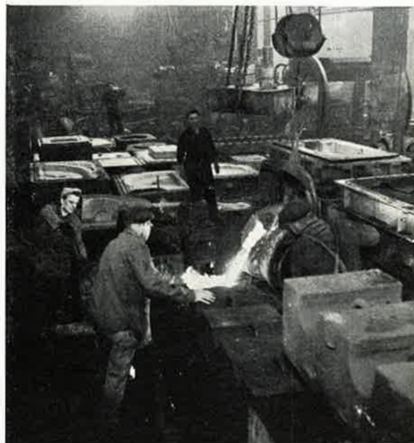
Putkivalukoneen neljän tonnin painoinen koneenrunko on juuri valettu ja kaasuuntuneet keernan sideaineet palavat kaasujen poistoaukkojen kohdalla
