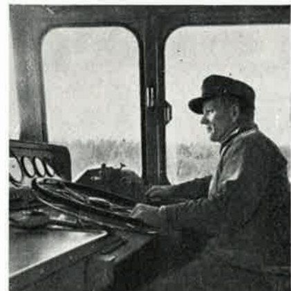
Auton rattia muistuttava pyörä on tehonsäätäjä
