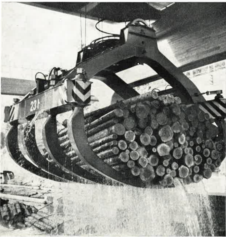
Muutamassa hetkessä puunippu siirtyy Kimolassa 12,5 m alemmaksi
