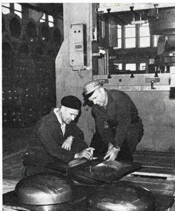
Puristajat Lauri Tiira ja Heikki Haajanen varmistamassa mittatikun avulla, että puristimessa muovautun lämmi- vesivaraajan kupari- vuoratun päätyosan syvyys on täsmälleen oikea
