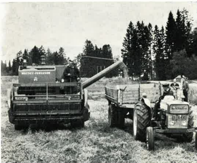
Leikkuupuimurin säiliön täytyttyä irtovilja tyhjenetään traktorin lavalle, josta se edelleen ajetaan kuivuriin
