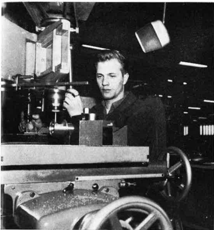
Työkaluhioja Kauko Sipponen tekemässä vaihtventtiilin säätölautasta kopiojyrsinkoneella
