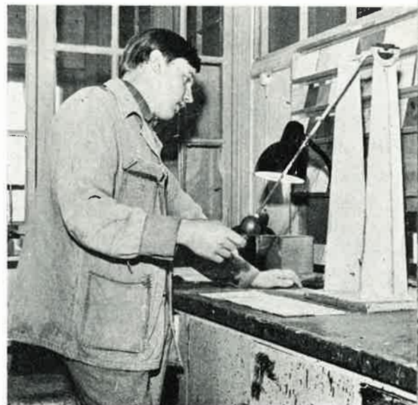
Jorma Kuusijärvi suorittamassa käytöntarkkailulaboratoriossa emalipinnan lujuuskoetta
