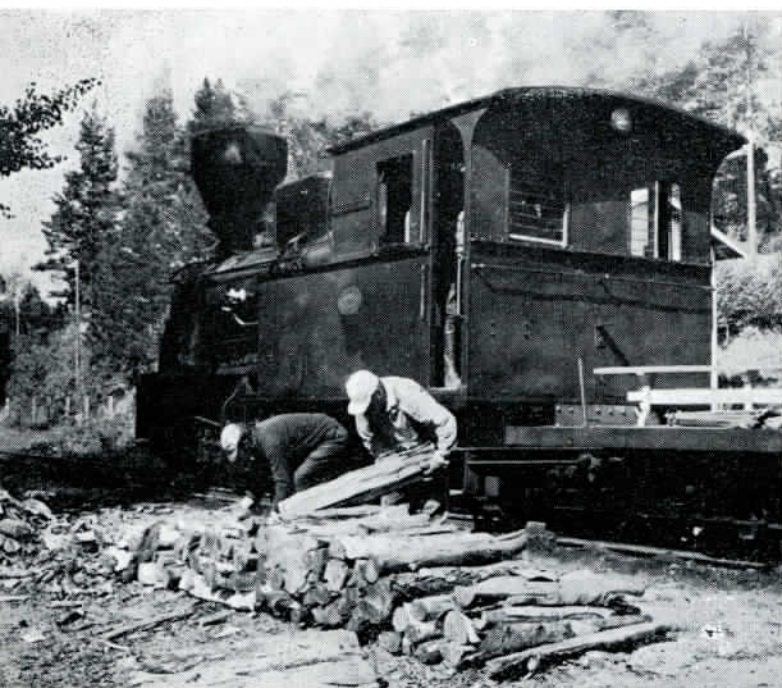
Tukkijunan vanhan vetojuhdan tulipesässä kuluu paremmanpuoleisia koivuhalkoja motin verran jokaisella matkalla ja vettä sille pumpataan runsaat 3 000 litraa joka tunnin päästä
