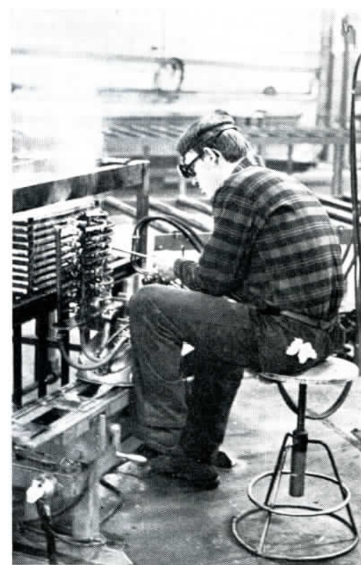
Hitsaaja Erkki Eskelinen työskentelemässä paneeliradiaattoreiden päänhitsauskoneella
