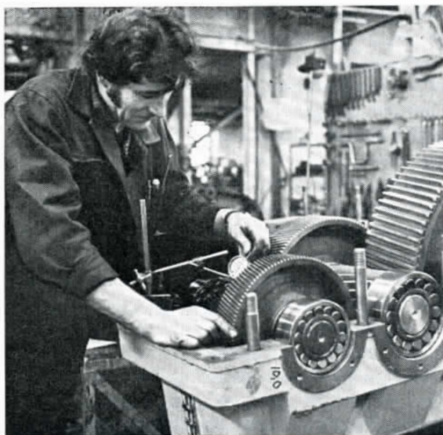
Santasalon tehtaalla Helsingissä on kestävää SG- rautaa käytetty hammaspyörien materiaalina jo lähes kymmenen vuoden ajan
