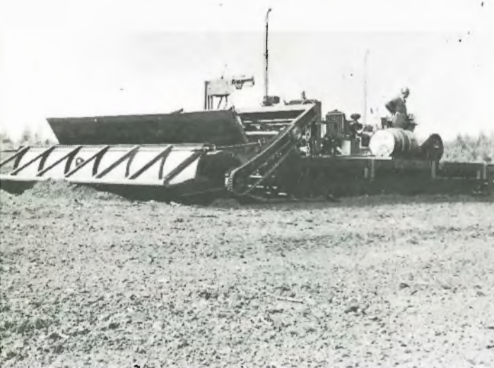
Vuonna 1969 valmistettiin Haukkasuon turvetyömaalla insinööri Ekelundin suunnittelema tehokas syväjyrsin, jolla juurinen ja kantoinen turvekenttä muokataan sopivaksi jyrsinturpeen nostomenetelmää varten.
