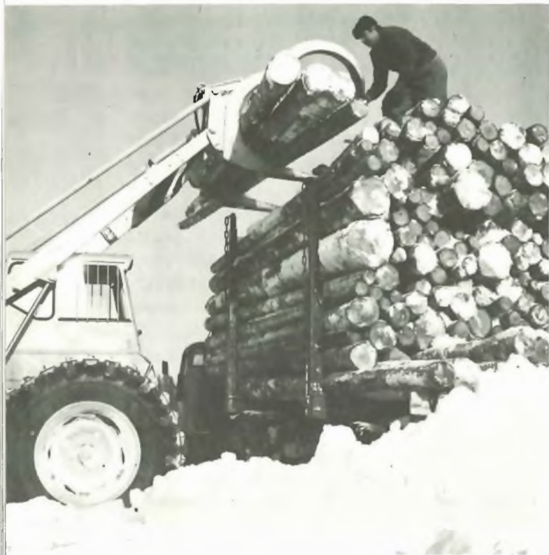
Kone on tullut yhtiön metsätyömaille. Kuormaa tehdään hydraulisella, puolitelaketjulla varustetulla haarukkatrukkikuormaajalla. Kuva v:ltä 1962.
