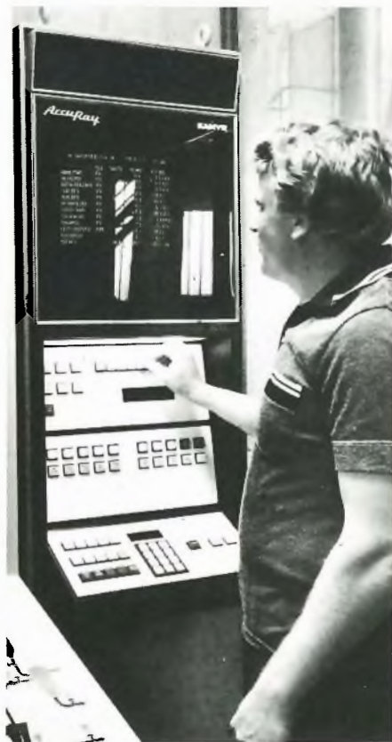
Koivukeittimessä (vas.) koivuhake keitetään selluloosaksi. Tätä prosessia ohjataan nyt tietokoneen avulla. Ykköskeittäjä Pertti Vainio 'keskustelelee' ohjaamossa tietokoneen kanssa keiton kulusta ohjausyksikön välityksellä.
