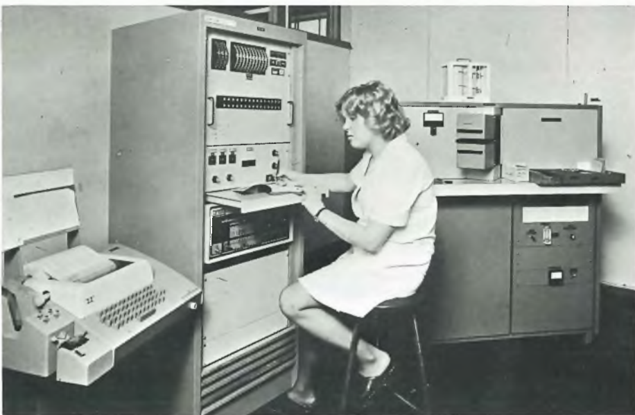
Karkkilan tehdasryhmän valimon vaativan teollisuusvalun laatua varmistaa mm. sulatusnäytteiden analysointiin 1975 hankittu spektrometri, jolla työskentelemässä laborantti Anja Lehtonen.
