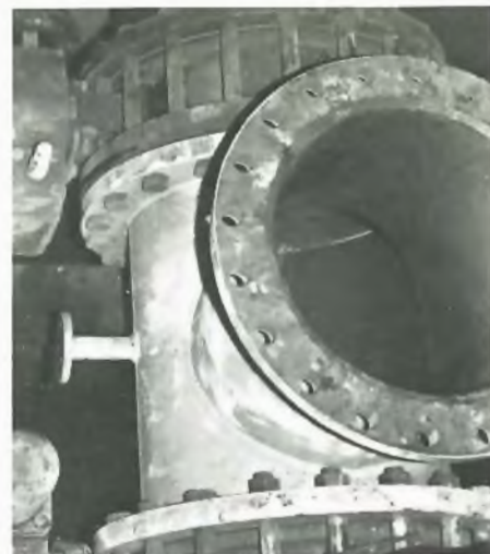
Valmetin Vuosaaren telakalla asennetaan Högfors-läppäventtiilejä mm. tankkilaivoihin lastinkäsittely-venttiileiksi.
