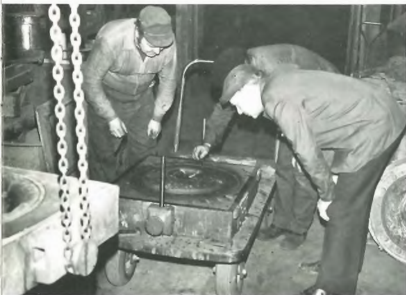
Tulevan taulun pinta tarkastetaan huolellisesti ennen valua. Kalevi Kallio raaputtaa ’lansetilla’ pinnan puhtaaksi Esko Seppälän ja työnjohtaja Auvo Astalan seurattessa työtä.
