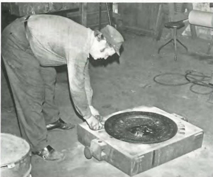
Taidevalun teko aloitetaan ’pimeästä pohjasta’. Esko Seppälä asettelee taulun ja valukanavien malleja paikoilleen.
