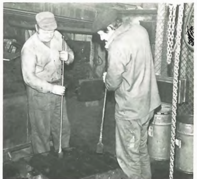
Musta hiekka täytyy saada tiiviiksi kerrokseksi muotin päälle. Esko Seppälä ja Kalevi Kallio tiivistämässä mustaa hiekkää ’käsiraamarilla’.
