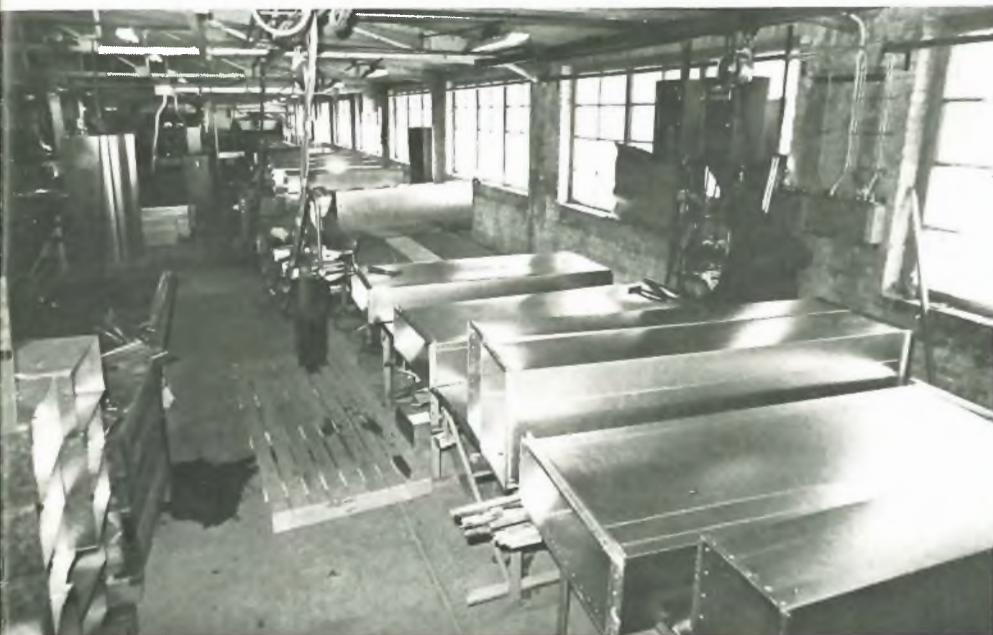
Suorakaidekanavalinjalla työskentelee tehtaan normaalikäynnin aikana 10-12 henkilöä. Kuvassa pistehitsataan kanavien tukiraameja.
