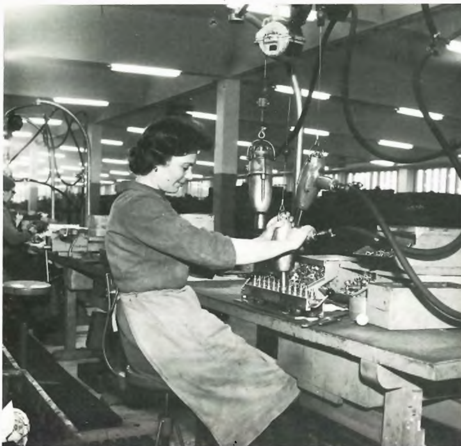
Messinkiventtiilien kasaamista paineilmalla toimivien työkalujen avulla.
