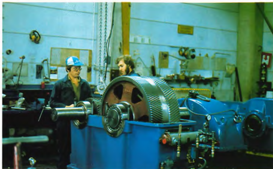
Asentaja Kari Prähky ja Beat Känell tarkastamassa hammaspyöriä ennen vaihteen kotelon paikalleen asentamista.
