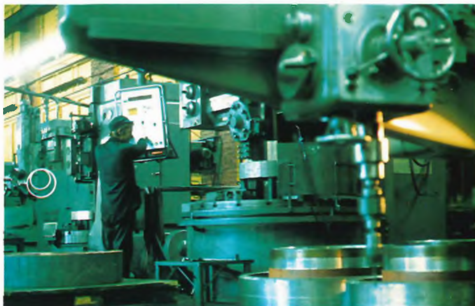
S-vaihteiden alkukoneistus tapahtuu Karkkilan konepajassa. Sorvaaja Martti Kuivalainen koneistamassa hammaspyöräaihiota konepajassa.
