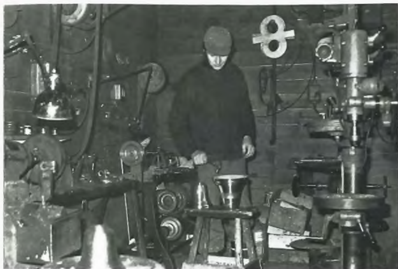
Elias Juutilainen kokeili kellon sointia. Soinnin ratkaisee tina, jonka määrä metalliseoksessa on tarkkaan määrätty. Liika tina halkaisee kellon.
