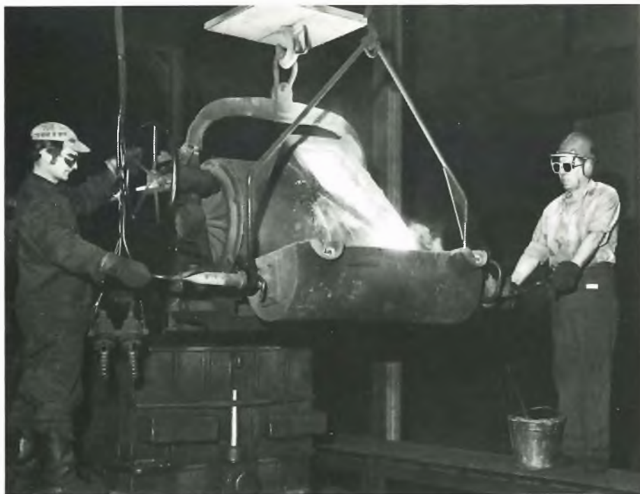
Ammeiden valussa ei viidenkymmenen vuoden aikana tapahtunut oleellisia muutoksia. Viimeisen Högfors-ammeen valun suorittivat Veikko Kuikka (vas.) ja Toivo Ruuska, jotka ovat parhaillaan aloittamassa viimeistä valua.
