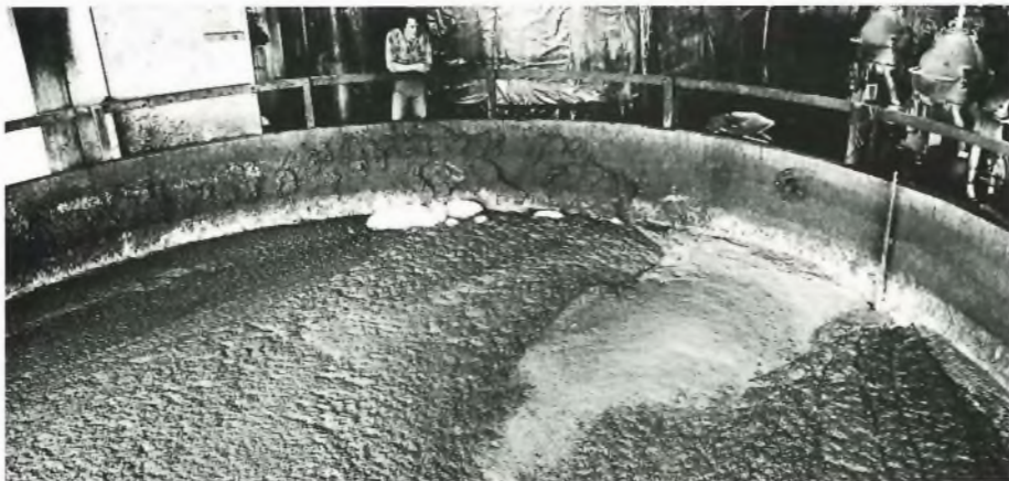
Jouko Junkkari valvoi käymisosaston hoitajana toimiessaan mm. ponttilankuista rakennettujen sammioiden täyttämistä ja tyhjentämistä. Liemen muuttuessa käymisen ansiosta vierteeksi muodostui sen pinnalle vaahtoa, joka poistettiin nesteen pintaa mitattaessa.
