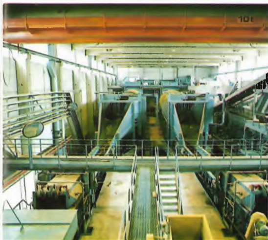
Katkaistujen sellupuiden kuorinta ja hakeutus tapahtuu kuorimolla. 26 metriä pitkät kuorimarummut ovat viisimetrisiä läpimitaltaan.
