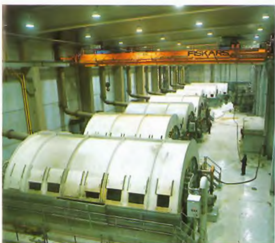
Keiton jälkeen sellu pestään, lajitellaan ja valkaistaan. Etualalla pesureita, takana oikealla syrjäytysvalkaisimon yläosa.
