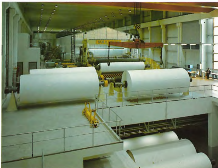
PK 3:n kuiva pää. Pituusleikkurin koneeseen toimitti A. Ahlström Oy:n Karhulan Konepaja. Erikoisuutena konehallissa on mm. se, että hallin lattia puristusosasta koneen toiseen päähän saakka on katettu parketilla.
