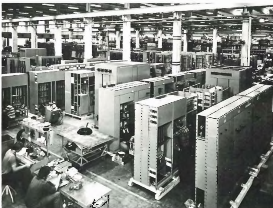
Kojeistotehtaalla kojeistot kootaan valmiiksi suuremmiksi yksiköiksi. Nämä kojeistot menevät Teollisuuden Voima Oy:n Olkiluodon ydinvoimalaan.
