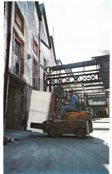
Sellupaalien siirto varastosta tehtaan toiseen kerrokseen tapahtuu erityistä 'serpeniiniväylää' pitkin.
