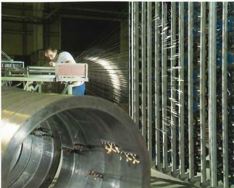
Loimi luodaan luontiosastolla valmiiksi kaseteille koneen vielä kutoessa edellistä lointa. Loimea valmistamassa kelaaja Vesa Toivanen.
