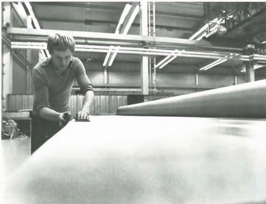
Ennen saumausta viirujen päät leikataan lankasuoraan. Tästä viiranvalmistusprosessin loppuosaan kuuluvasta vaiheesta vastaa mm. saumaaja Eino Tirkkonen.
