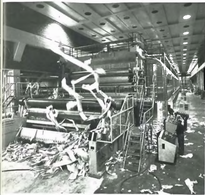
Paperirata on levinnyt parikymmensenttisestä koko koneen leveydelle. Lauantaiamuna 18.11. klo 4.52 syöksähti paperia ensimmäisen kerran koneen kuivasta päästä. Sunnuntaina 19.11. syntyi kaksi ensimmäistä virheetöntä tampuuria.
