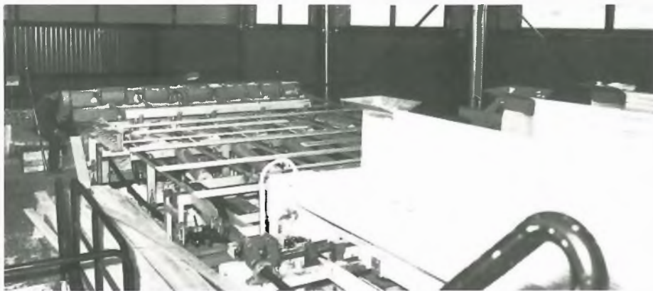
Rimoitus on Soinlahden uudessa sahassa koneellistettu. Aiem-min rimoitus vaati kymmenen työntekijää, nyt tullaan toimeen kolmella.
