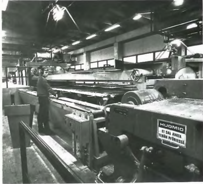
Särmäyssahoilla, joita Soinlahdessa on kaksi, määrätään sivulautojen leveys. Leveyden valinnassa auttavat särmääjää syöttöpöydän yläpuolella olevat varjoviivalaitteet. Särmäyksen jälkeen laudat siirtyvät tasaamoon.
