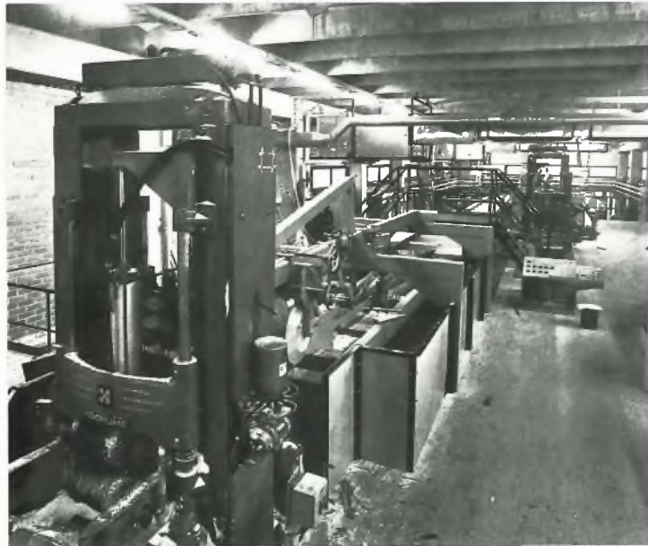
Soinlahden uusi kehäsahalinja on tehokas: minuutissa sahataan 3–4 tukkia. Saharakennus on sisältä lämmin ja valoisa. Työntekijöitä hallissa tarvitaan aiempaa vähemmän, koska tietyt aputyöt on voitu rationalisoida pois.
