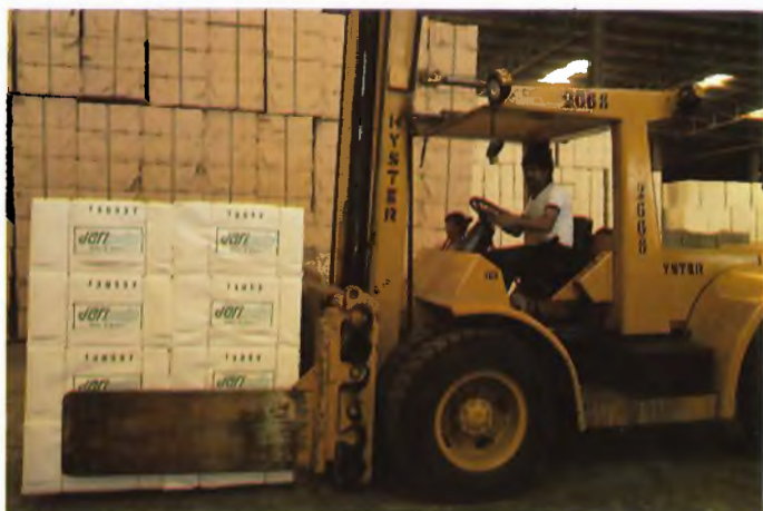
Kauniit valmiit sellupaalit siirretään paalauspuristimelta varastoon trukeilla. Varastosta laivan äärelle paalit kuljetetaan lukeilla. Kuvan vaaleat paalit Jarin markkinamassaa.
