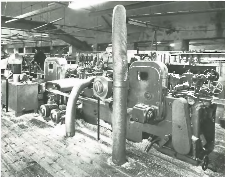
Hallan jalostustehtaan höyläämön tehokkain kone on vuonna 1970 hankittu Jonsered-höyläkone. Tarvittaessa voidaan lauta höyläämön tiloissa myös halkaista tarvittavaan leveyteen.
