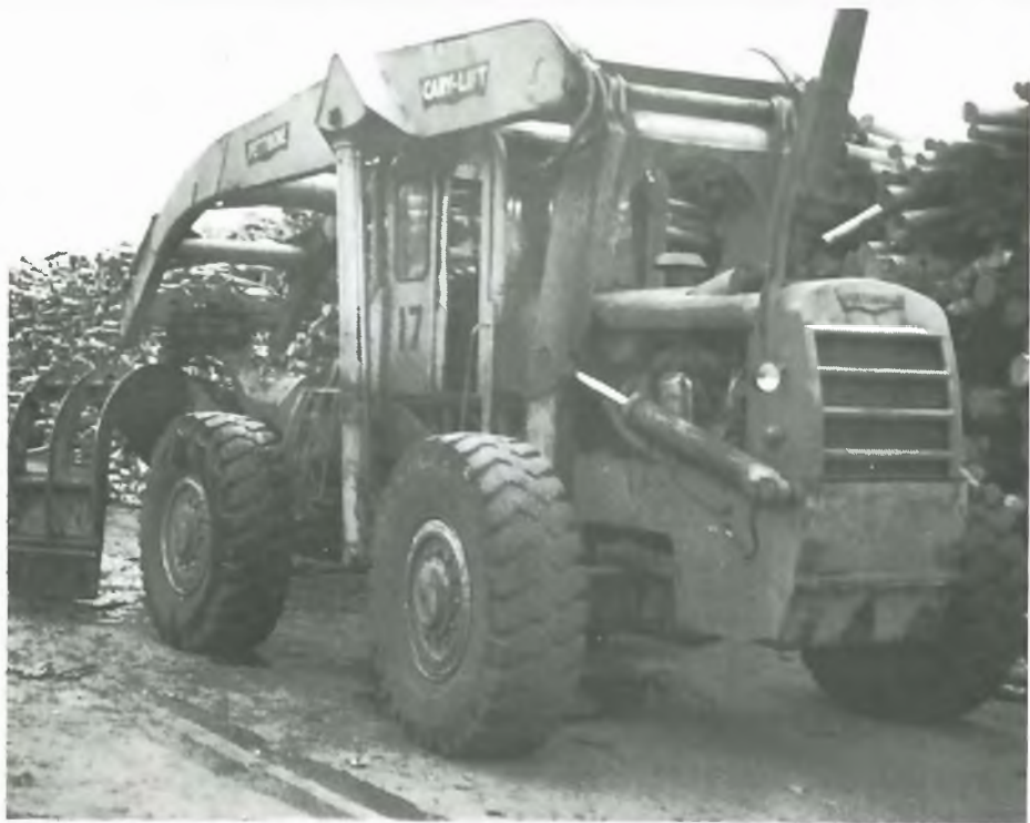
Kuusankoskella käytössä oleva kauhakuormaaaja, missä käytetyillä Kymenite-holkeilla on säästetty holkkien vaihto- ja koneen seisontakustannuksissa saman verran kuin mitä holkit maksaisivat tehtynä kullasta.
