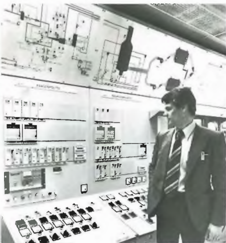
Hajukaasujen polttoa ohjataan ja valvotaan soodakattilan ohjaamosta.
