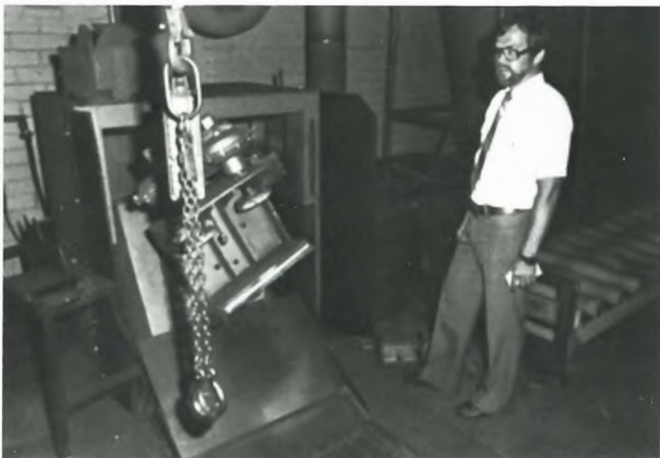
Liitteiden meislauksen helpottamiseksi hankittiin osastolle manipulaattori, joka mahdollistaa kappaleen kääntelemisen haluttuun asentoon konevoimalla. Aiemmin isotkin liitteet siirrettiin hartiavoimin. Laitteen toimintaa esittelee tuotantopäällikkö Taisto Lappalainen.
