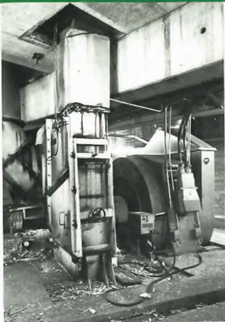
Sellutehtaan kuorimon aiheuttama melu on alle 100 dB(A), koska hakku on sijoitettu omaan betonibunkkeriin ja irralleen muusta lattiasta.
