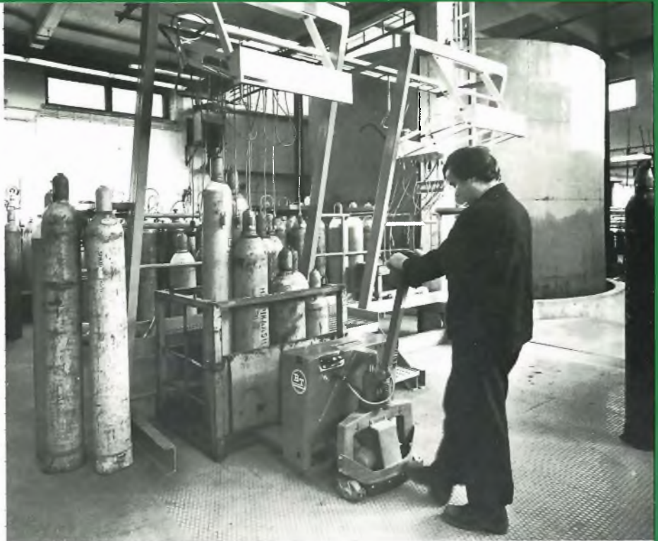
Kuljetushäikeissä asiakkailta tulleet happipulot jouduttiin aiemmin yksitellen vierittämään sekä täytettäväksi että täytön jälkeen lastattavaksi. Tällä hetkellä voidaan kuvassa olevan sähkötrukin avulla siirtää koko kehikko uudelle täyttöpaikalle. Tapaturmariskejä aiheuttanut pullojen vierittäminen on näin vähentynyt Voikkaalla sijaitsevalla ilmatehtaalla.
