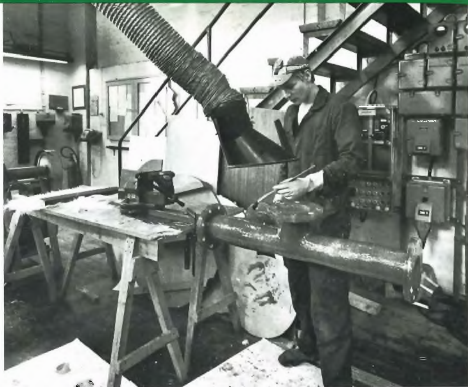
Laminointityössä syntyvien kaasujen poistamiseksi työtiloista on Kymin muovipajalla otettu käyttöön kaksi kohdeimuria. Imurin suutin voidaan vapaasti siirtää laminoitavan kappaleen kohdalle. Aiemmin työturvallisuutta on parannettu siirtämällä komponenttien sekoitus erilliseen ilmastoituun huoneeseen.
