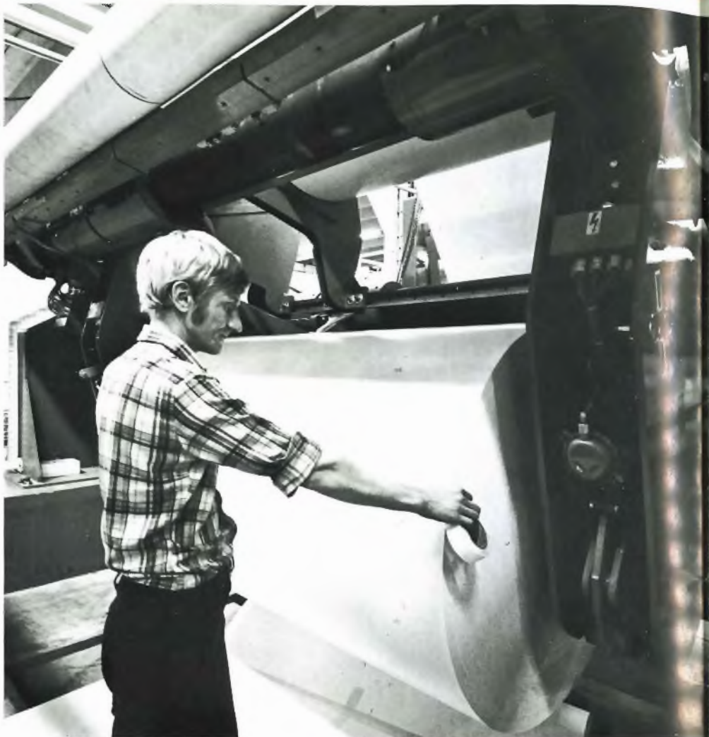
Leikkurin hoitaja Pekka Kettunen liimaamassa lennossa tapahtuvan rullanvaihdon mahdollistavaa teippiä käsittelyä odottavaan kartonkirullaan. Kettunen on toinen kahdesta leikkurin hoitajasta, jotka saivat opastusta koneen käyttöön Inkeröisissä.
