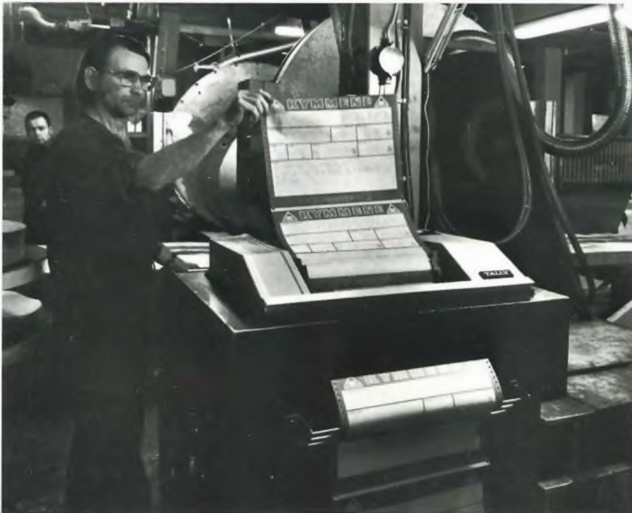
Prässimies Armas Ruippo on tyytyväinen Voikkaan rullapakkauslinjalla sijaitsevaan päätteeseen, joka kirjoittaa automaattisesti laivausetiketit sekä rullan päätyyn että vaippaan. Aiemmin merkinnät tehtiin käsipelillä.
