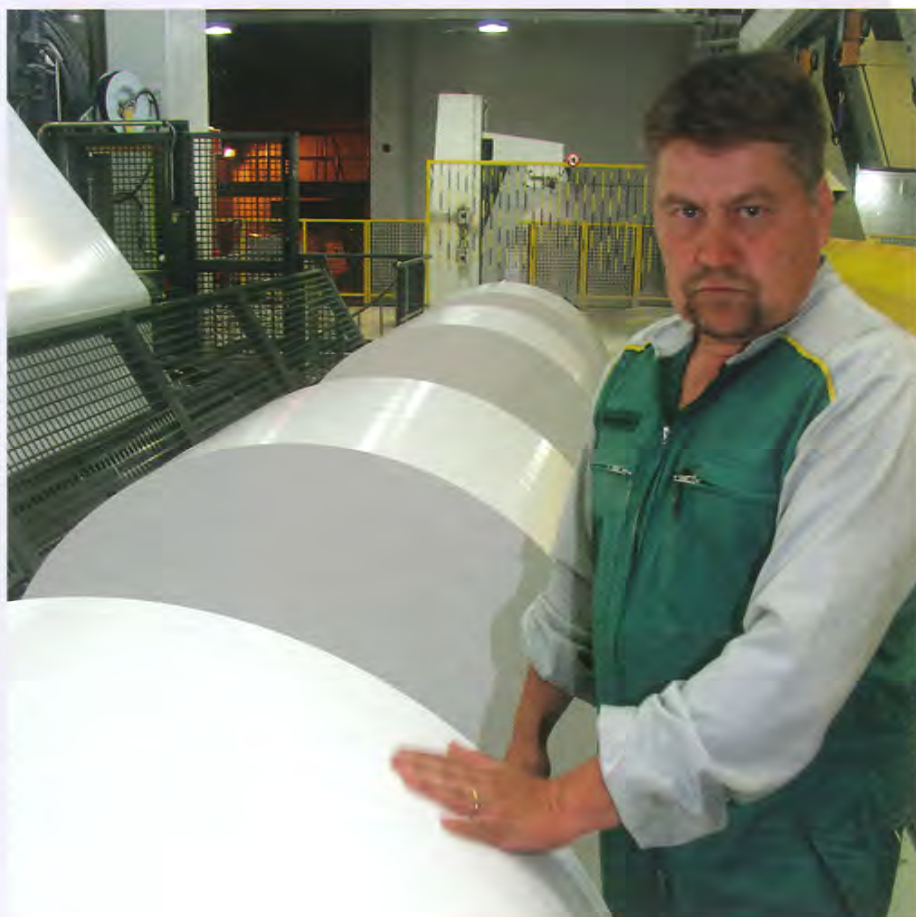
Pituusleikkurin ajomies tekee viime kädessä päätöksen, menevätkö rullat pakkaukseen, jälkileikkurille vai pulperiin. Usein ratkaisu edellyttää myös rullien silmämääräistä tarkastelua ja pinnan tunnustelua käsin. Työssä ykkösajomies Pekka Lillrank.
